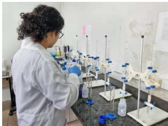
**Figura 01.** Aparato para extração de elementos metálicos (catiônicos) presentes em água do mar (uma matriz salina próxima ao mineral halita dissolvido).
