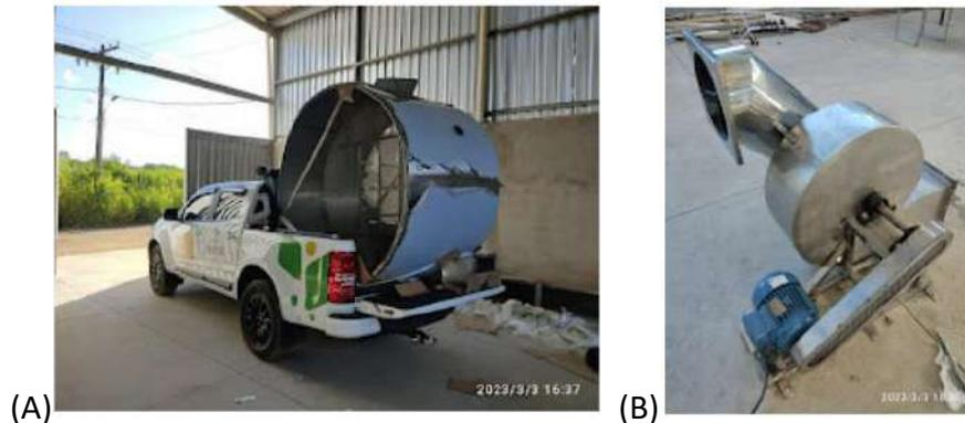
**Figura 01.** Vista parcial da fábrica dos equipamentos, localizada em Timóteo – MG e do carregamento para transporte do mesmo. Câmara de secagem sobre o veículo (A), Ventilador centrífugo e motor (B). São Mateus – ES. 2023.
