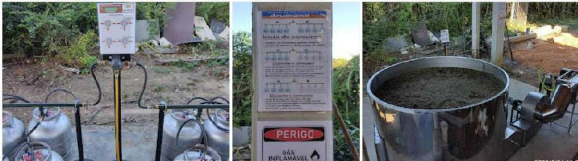
**Figura 04.** Vista parcial de uma batelada de secagem de pimenta do reino, utilizando-se o secador circular estático, o gerador de calor e a central de gás. São Mateus – ES. 2023.
