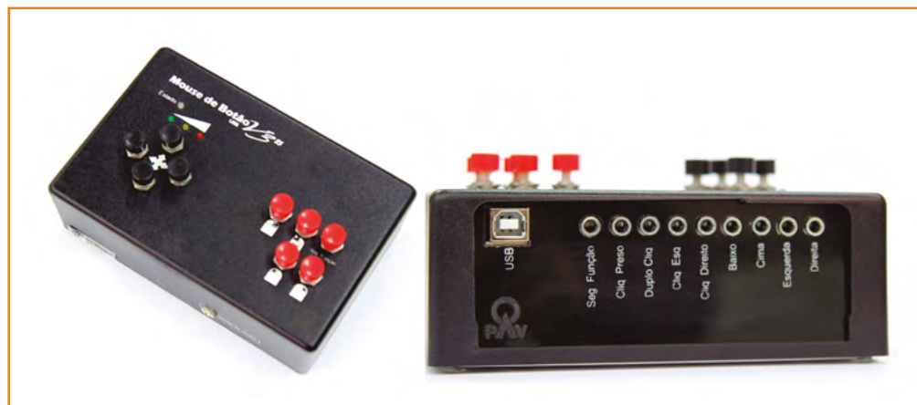
Figura 3: Mouse de botão e sua lateral contendo entradas para acionadores
